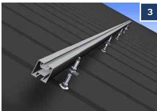
Montare il profilato per ogni sequenza di pannelli, utilizzando viti e dadi: (nella figura 2 possono essere utilizzati anche dadi autobloccanti DIN 985 con rondelle piane, coppia di serraggio massima 18 Nm.)
