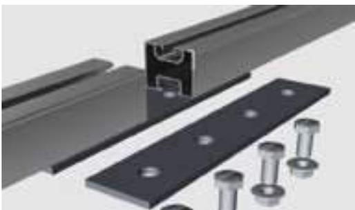
Prendere 4 viti a testa esagonale per la piastra di giunzione (a 4 fori) e infilare le prime due nella scanalatura inferiore del primo profilato. Successivamente infilare le ultime due viti nell'altro profilato. Per concludere l'operazione, fissare tutte le quattro viti con quattro dadi. (Coppia di serraggio: 10 - 12 Nm)
